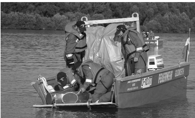
Die auf der Rolle gelagerte Ölsperre wird an der vom A-Boot Ottensheim ausgebrachten Boje befestigt und anschließend ausgelegt.
