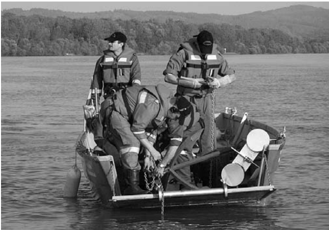
Die Mannschaft des Ottensheimer A-Bootes beim Aussetzen einer Befestigungsboje für die Ölsperren.
