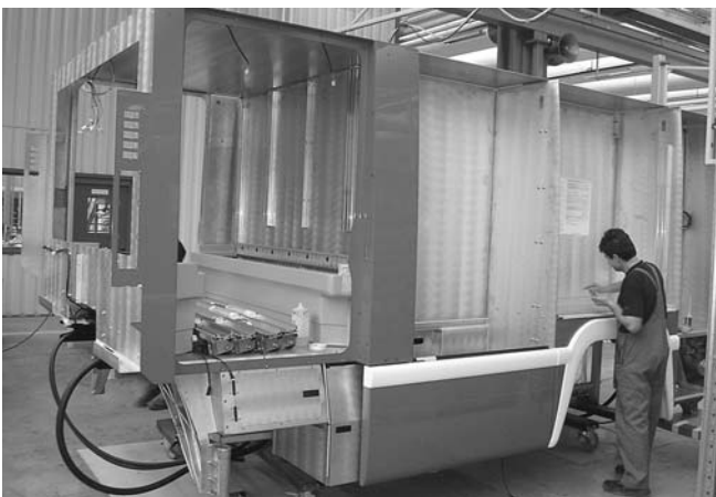
Der Aufbau wurde aus Aluminium gefertigt, um Gewicht einzusparen.
