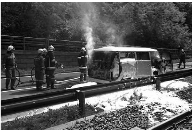
Wie auf diesem Bild zu sehen, ist der Brand vom Motorraum ausgegangen und hat sich dann auf das Innere des Fahrzeugs ausgebreitet.
