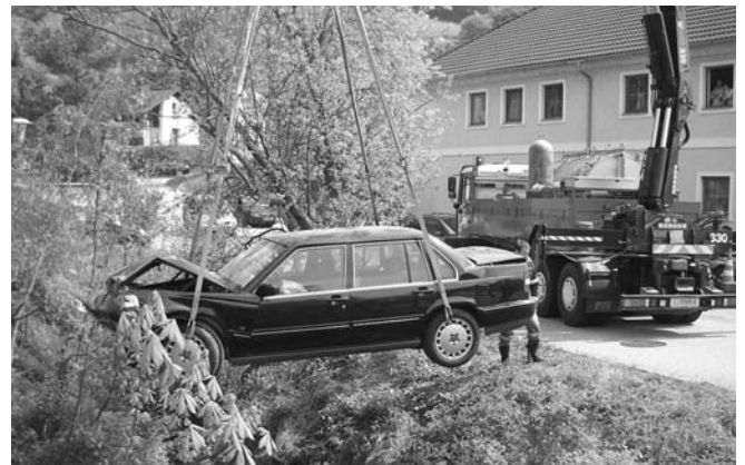
Mit dem LAST Alkoven konnte das Auto, ohne weitere Schäden zu verursachen, geborgen werden.
