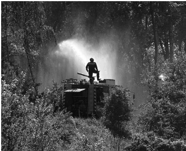
Brandbekämpfung mit dem Monitor vom RÜST aus. Gespeist wurde durch das A-Boot Walding direkt aus dem Altarm, Wasserverbrauch rund 1.200 Liter in der Minute.
