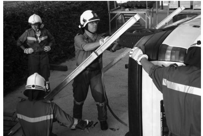
Auf einer Seite des Fahrzeugs wurde ein Umkippen mit Leiternteilen und Spanngurten verhindert.
