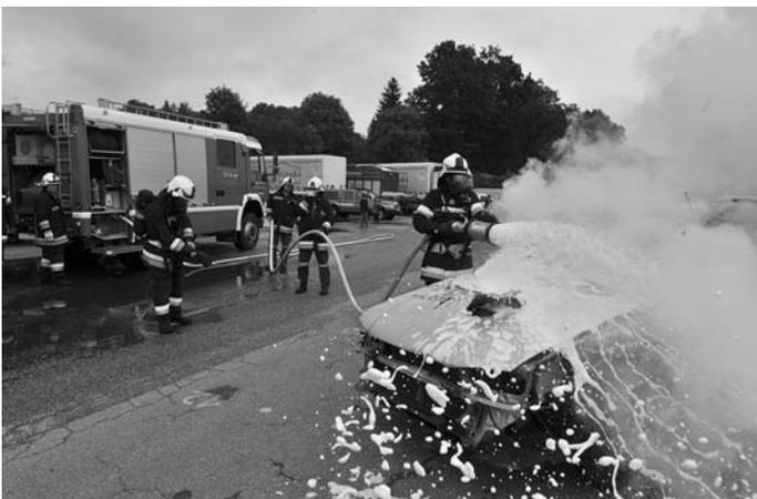
*Das brennende Fahrzeug wurde unter schwerem Atemschutz mit Mittelschaum gelöscht, um ein sicheres Arbeiten für die Rettungstrupps zu gewährleisten.*
