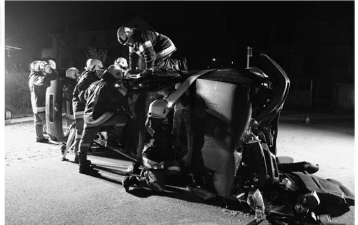
Hier wird mittels eines B-Schlauchs eine sogenannte Affenschaukel unter dem Verunfallten aufgebaut, um eine möglichst schonende Rettung des Opfers zu gewährleisten.
