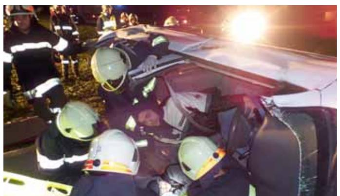
Bevor das Opfer befreit werden konnte, musste das Dach des Fahrzeugs entfernt werden (Rettungsöffnung).
