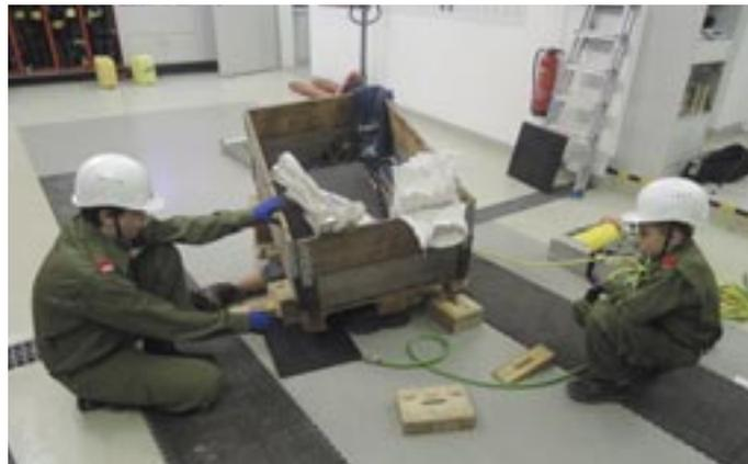
Mit einem Hebekissen, welches nur mit Druckluft versorgt wird, konnte die Übungspuppe schonend gerettet werden.
