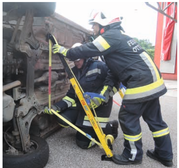
Mit diesen Stützen (Stab Fast) können Unfallfahrzeuge gesichert werden.
