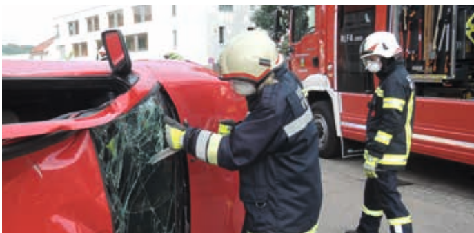
Mit der Glassäge wird hier die Frontscheibe aus dem Rahmen getrennt.
