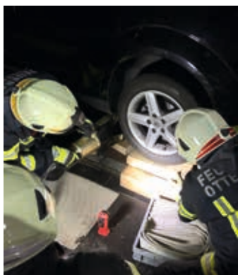
Mit dem Spreizer wurde das Fahrzeug angehoben, um einen Unterbau herzustellen.
